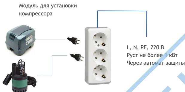
Рис. Принципиальная электрическая схема подключения станции
