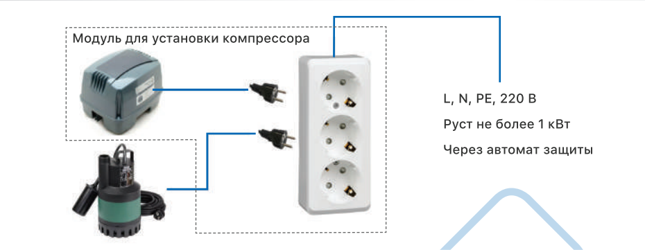
Рис. Принципиальная электрическая схема подключения станции
